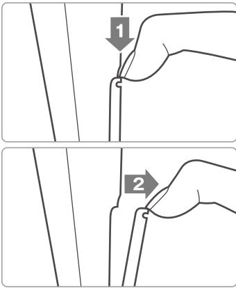
①本体裏側にカバーを外すためのくぼみがあるので、爪などを入れて引っかけ、カバーを軽く下に押し込みながら手前に引いて外します。
