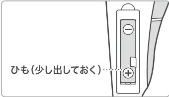
②単4電池のプラス側、マイナス側の向きを確認し、ひもは電池の下になるようにして電池を入れてください。
