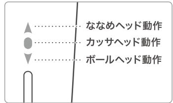
使用ヘッド表示ランプは、上図の通り点灯している箇所のヘッドが動作します。電源/切替ボタンを押すことで使用ヘッドの切り替えが可能です。
